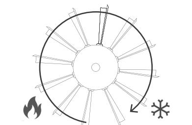
Los sistemas abrasivos convencionales se encuentran en contacto permanente con la superficie de trabajo durante el proceso de trabajo. Esta diferencia de acción, permite que las láminas abrasivas **MultiFlex no se saturen y tengan una vida útil mucho mayor** (de hasta 50h por set de lijas).
